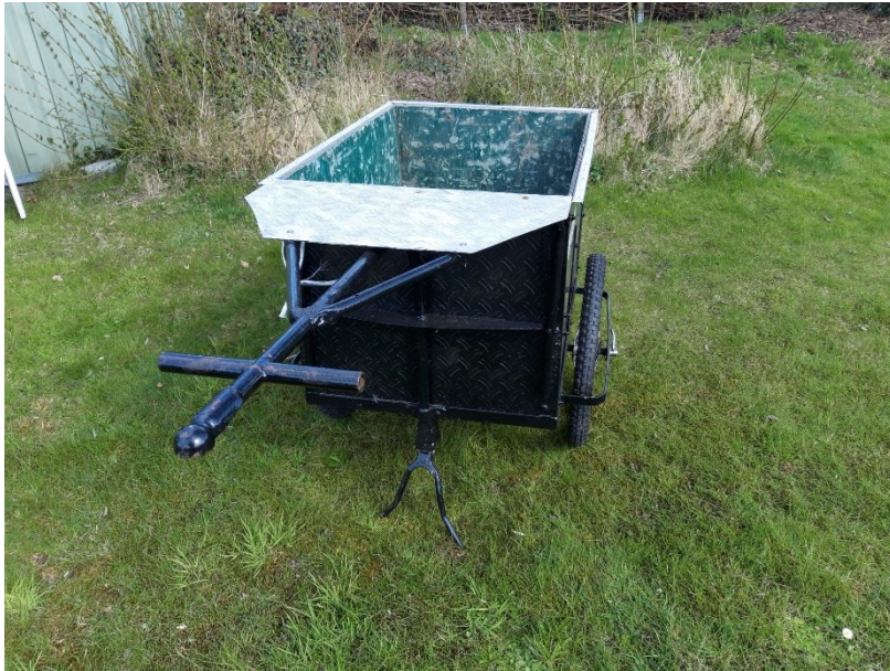
Figure 2: Vorderansicht mit Halbkugeladapter für die Fahrradseitige Anhängerkupplung.
