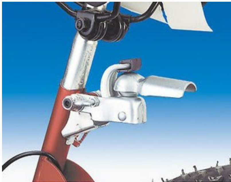
Figure 3: Bei Transport mit dem Fahrrad ist eine Kupplung am Rahmen des Fahrrades im Bereich der Sattelaufnahme notwendig.
